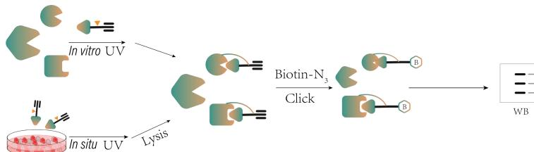
检测炔基化学探针(光亲和化学探针或共价反应化学探针)对蛋白质的标记效果。主要流程包括化学探针标记, 基于点击化学(Click)反应的生物素报告基团偶联, 后续可用于Western blot分析化学探针标记信号, 评估化学探针是否能够标记蛋白及标记强度。
